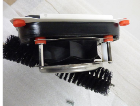
Figuur 2 Borstel vuil van de waaiers
