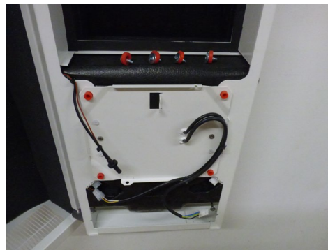
Figuur 14 Ventilator kan worden uitgetrokken
