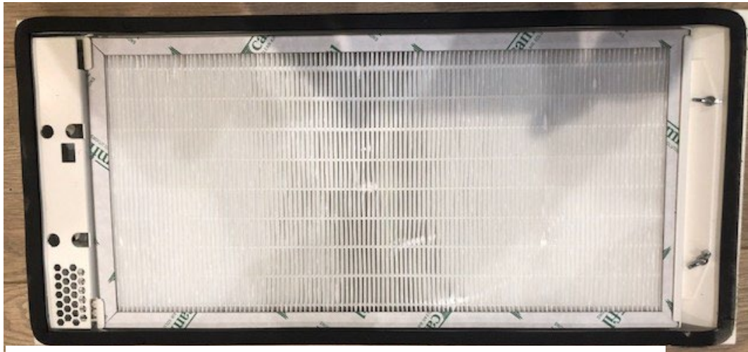
Figuur 11 Achterkant van de ultrafijnstoffilter na het uithalen uit de Fresh-r
