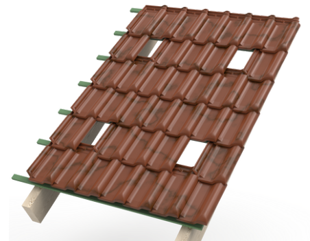
Stap 3.1: Dakpannen verwijderen
