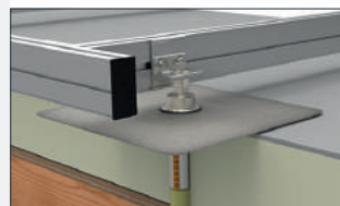
GEÏSOLEERD DAK HOUTEN PLAATMATERIAAL
