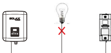
Onjuiste verbinding tussen belasting en omvormer
