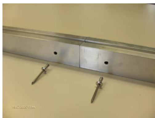
Afb. 23: Boren der profielen met boor \varnothing 4,9 voor 2 St. platbolkopnieten 4,8x10
