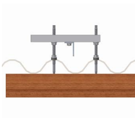
Afb. 14.1: Gemonteerde stokschroeven met montageplaat Duo en Alu-L-Profil (zijaanzicht)
