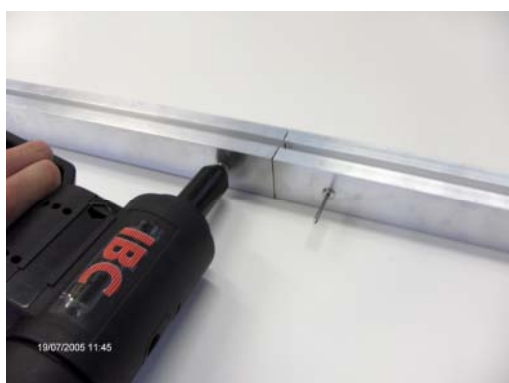
Afb. 24: Klinken der profielen met aansluitverbinding
