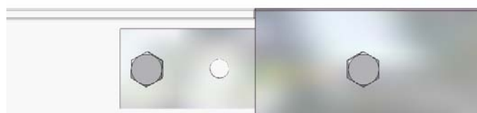
Afb. 36: Aansluitverbinding voor dakhaakverbinder Alu-L-profiel 60x40x5
